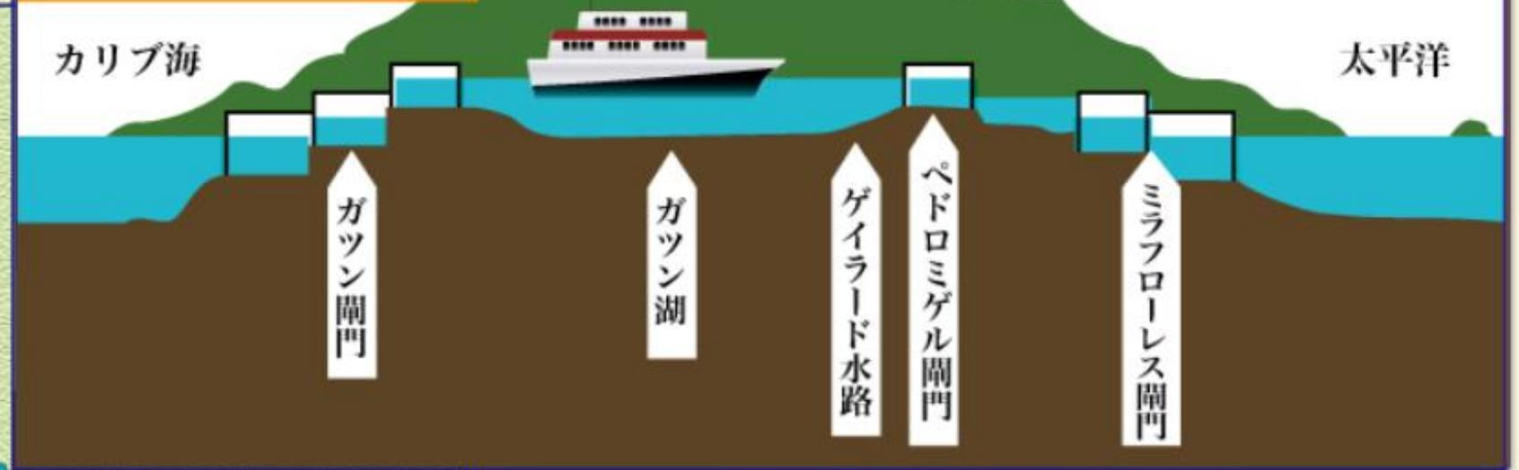
旧運河を通航可能な船舶は、全長294m、全幅32.3m、喫水12mまでに限られます。水門式エレベーターで、上下しながら進んでいきます。3つの水門を通過して進み、途中ガツン湖では、熱帯雨林の水道を進み、冒険気分も味わえます。
